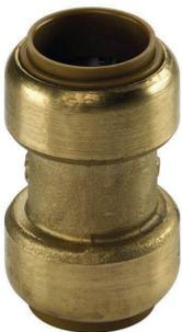
Das Tectite-System wurde für eine einfache, effiziente und sichere Installation entwickelt. Der Fitting wird, nach dem Entgraten des Rohres, mit einer leichten Drehbewegung auf das Rohr gesteckt. Nach dem deutlich hörbaren „Klick“ ist eine dauerhaft dichte Verbindung nach DIN 1988 hergestellt.
